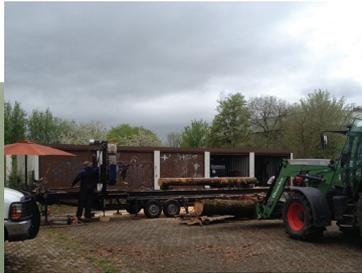
30 Festmeter Holzstämme aus dem Lollarer Gemeindeforst wurden für die CBES-Holzwerkstatt zugeschnitten, darunter Buche, Eiche, Kiefer, Kirschbaum und Birke. Gesägt wurden sie von einem mobilen Sägewerk. Die Rinden wurden geschält und die Bretter und Bohlen daraufhin mit Leisten zur Durchlüftung im Holzschuppen im Schulgarten zum Trocknen aufgesetzt.
